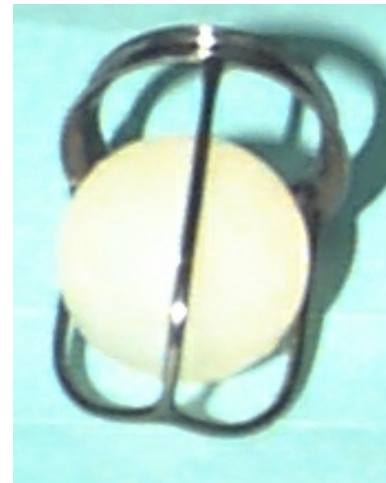
Figura 2 - Válvula de bola de Starr-Edwards. (a) Desenho esquemático. (b) Fotografia da válvula utilizada nos testes
